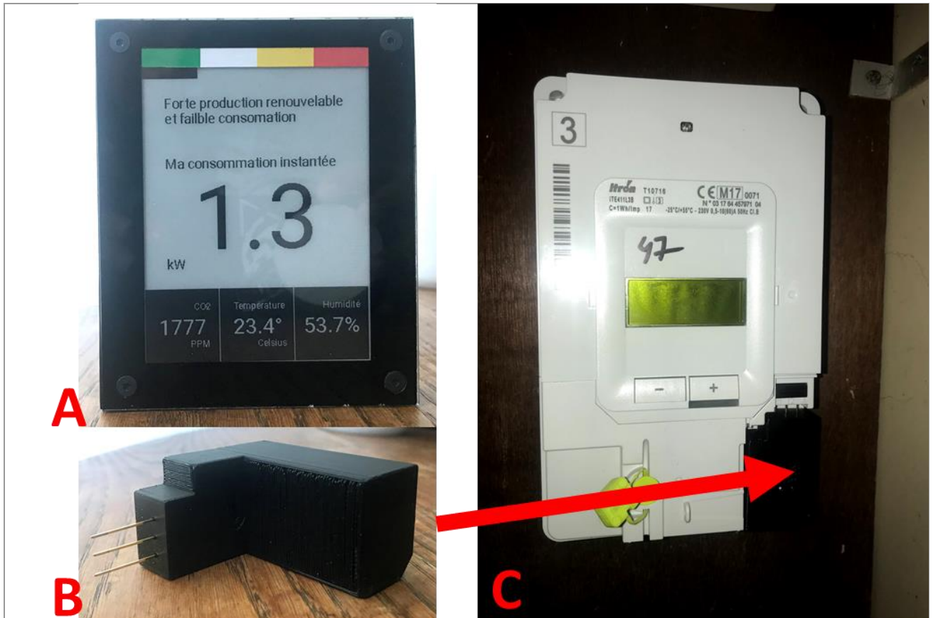
Figure 1 : Photos de l'afficheur (A), du module de collecte de données (B) et du module installé sur le Linky (C)
