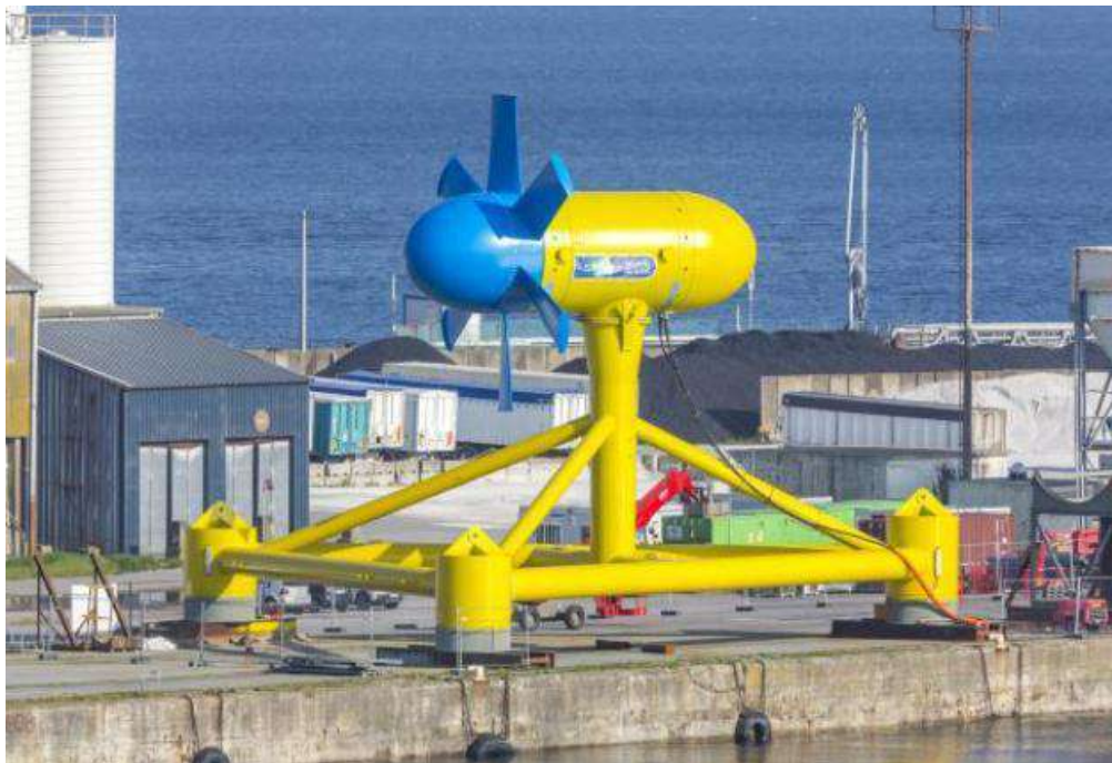
Figure 2.27 La turbine marémotrice Sabella D10 dans l'aire d'assemblage de Brest (Paboeuf et al., 2016).
