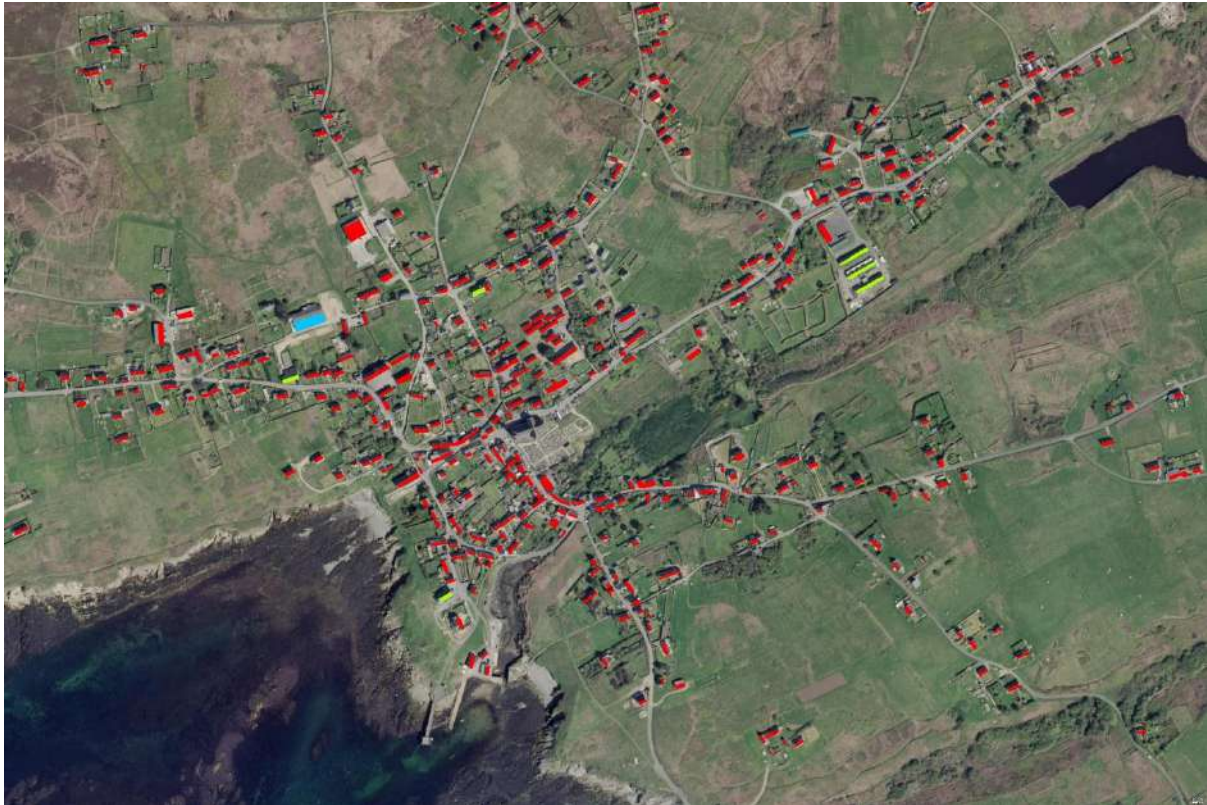
Figure 2.15 Carte de Lampaul montrant les sites de toits solaires. L'installation solaire PV en service sur le centre sportif (en bleu), les projets solaires prévus (en vert) et les sites potentiels sur toiture (en rouge) apparaissent. (Source de la carte de référence : IGN)
